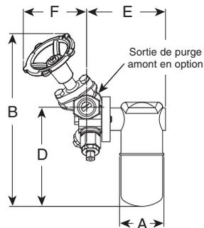
Modèle TVS-4000 avec purgeur série 2000 en acier inox.
