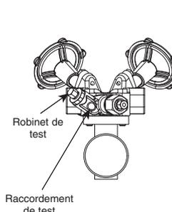
Modèle TVS-4000 avec purgeur série 2000 en acier inox.
